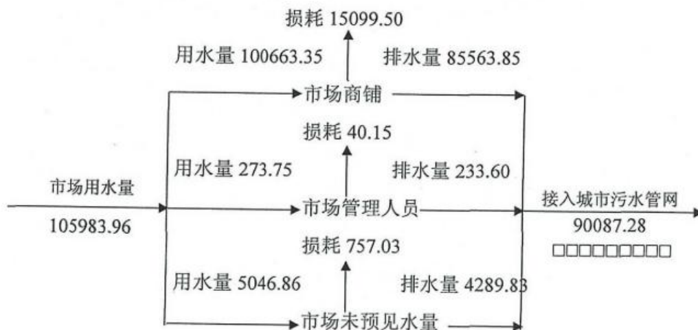
图 2.5-1 项目市场用水平衡图 单位 t/a
